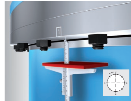
Figura 8: Estructura principal de la medición de asentamiento con calibre de profundidades
