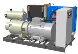
Se o compressor de ar for um modelo mais antigo com um sistema de arranque estrela/triângulo, então será necessário instalar um motor eléctrico com 20% mais potência, ou adicionar um Inverter para alimentar o motor eléctrico com a mesma frequência original.
